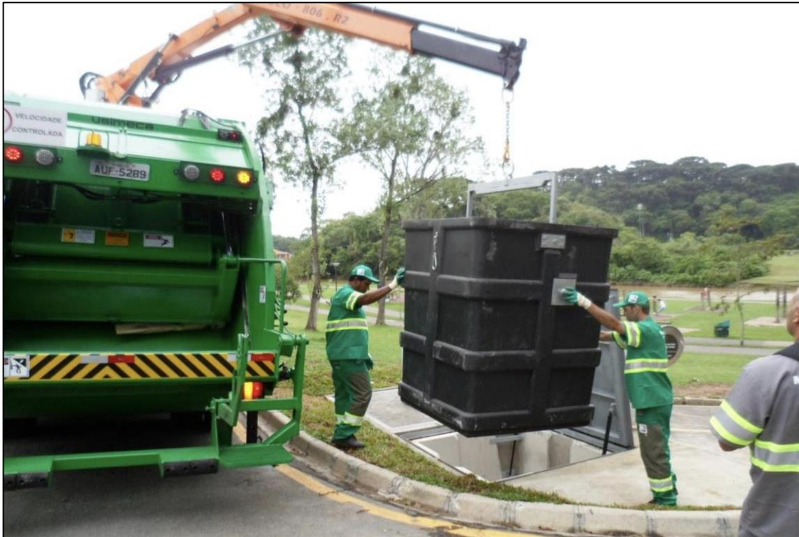
**Figura 44 – Exemplo de Coleta dos Contentores Subterrâneos.**
