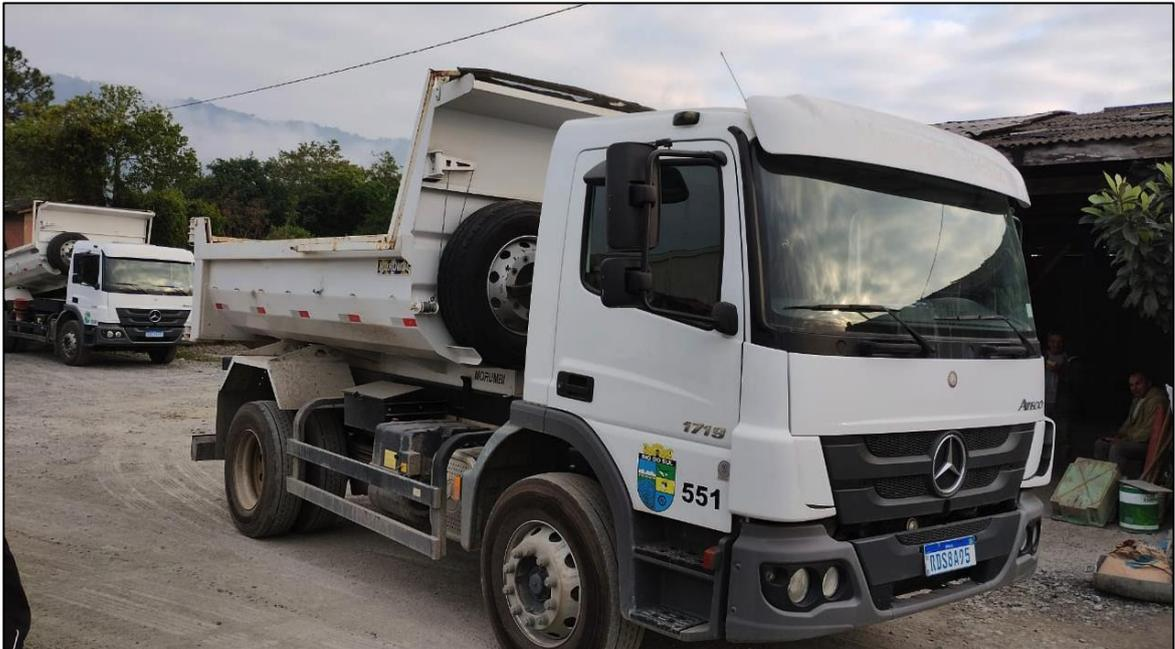
**Figura 31 – Transporte de RLP - caminhão caçamba de 6 m<sup>3</sup>**
